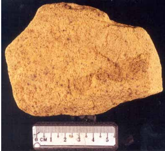
شكل Y.2 حجر رمل أصفر إلى برتقالي اللون، ليمونيتي، من متكون الوسيح، البوبيبات، شمال غرب مدينة الرياض، تصوير: مشرف
